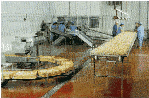
Un carrousel de caisses de 102 poussins, un tapis de poussins et des trieuses qui mettent en condition les poussins sans problèmes. Les pertes totales sont très faibles de l'ordre de 2% dans l'ensemble de la chaîne.
